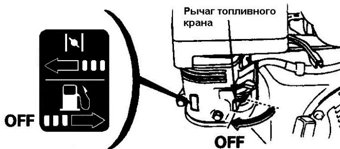
Рисунок 12 – Рычаг топливного крана в положении "OFF" ("Выключено")
